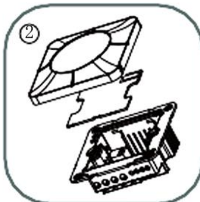
2 Separar el panel frontal de la pieza que contiene las conexiones (que es el transformador). Desconectar el cable del socket
