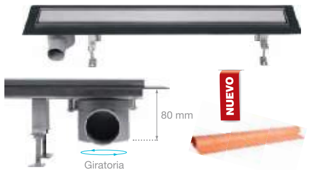
Canaleta Brillance 700 mm con válvula 65 mm · Fabricada en acero inoxidable AISI 304 · Válvula de 65 mm con salida a desagüe de Ø 50 mm
