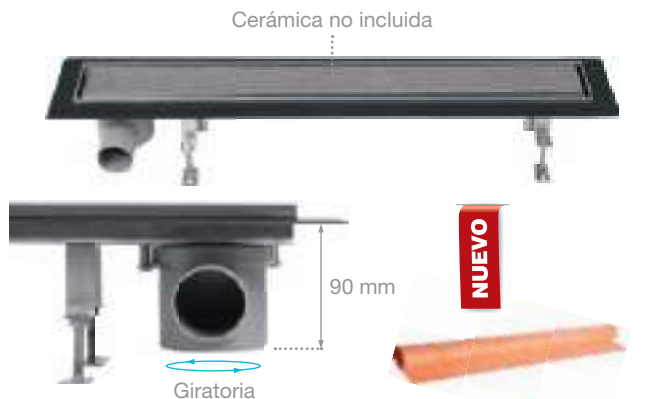
Canaleta Flat 700 mm con válvula 75 mm · Fabricada en acero inoxidable AISI 304 · Válvula de 75 mm con salida a desagüe de Ø 50 mm
