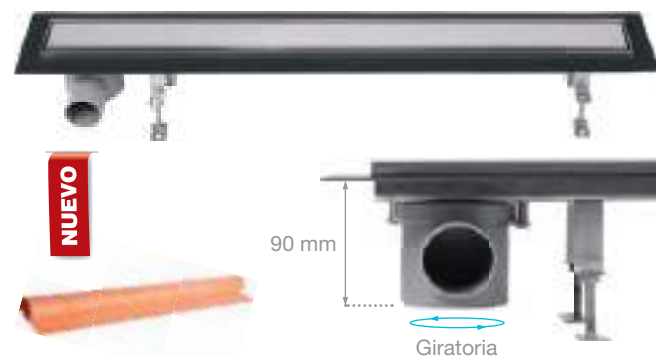
Canaleta Brillance 800 mm con válvula 75 mm · Fabricada en acero inoxidable AISI 304 · Válvula de 75 mm con salida a desagüe de Ø 50 mm
