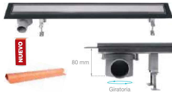
Canaleta Brillance 800 mm con válvula 65 mm · Fabricada en acero inoxidable AISI 304 · Válvula de 65 mm con salida a desagüe de Ø 50 mm
