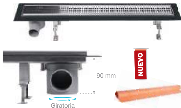
Canaleta Quadro 700 mm con válvula 75 mm · Fabricada en acero inoxidable AISI 304 · Válvula de 75 mm con salida a desagüe de Ø 50 mm
